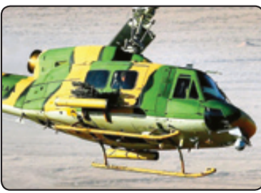
بالگرد ترابری ۲۱۴ مجهز به سامانه الکترواپتیکی زیر دماغه و راکت‌انداز هفت تایی در کنار بدنه
