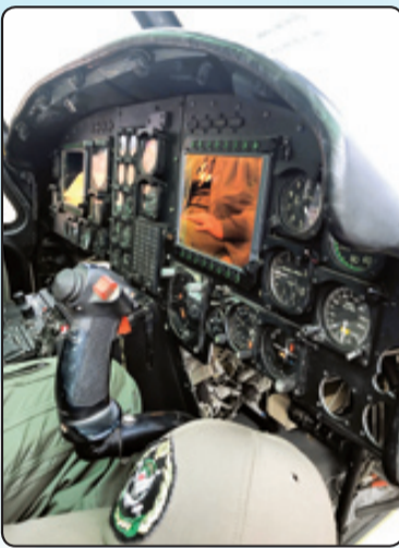
دو نما یشرگرد دیجیتال نصب‌شده در کابین بالگرد ترابری در کنار نمایشگرهای قبلی
