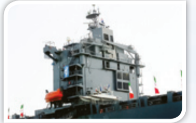
سازه روی ناو شهید مهدوی با ۸ طبقه و عرض نزدیک به ۳۰ متر ابعاد با قایق تندرو و ریب ۲۳ ده متری مستقر روی عرشه قابل مشاهده است
