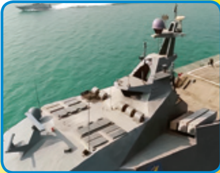
موشک‌های کروز با پرتابگرهای مایل در سمت راست تصویر، در پیچه پرتابگرهای عمودی روی سقف و تجهیزات راداری و الکترونیکی نصب شده روی ناو شهید سلیمانی
