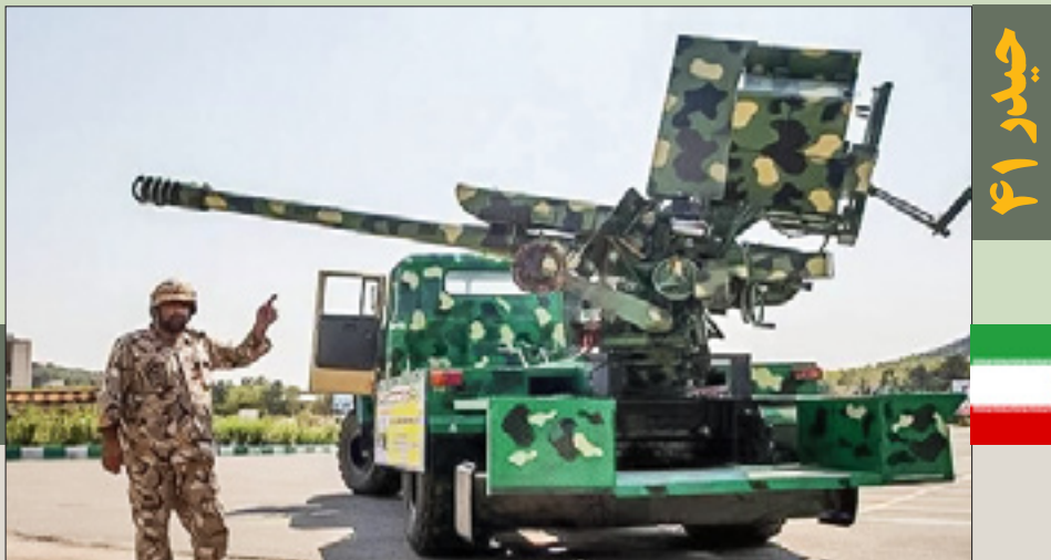
حیدر ۴۱ که سامانه بارگذار خودکار آن به صورت یک خشاب مکعبی شکل به خوبی مشخص است
