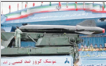
➤ موشک رعد، ورودی‌های هوای موتور جت در کنار بالک‌های انتهای بدنه مشخص است
