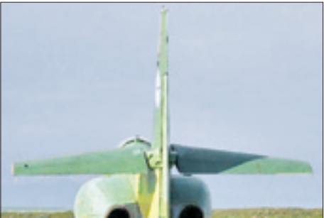
دم افقی کاملاً متحرک هواپیمای یاسین با زاویه حمله مثبت
