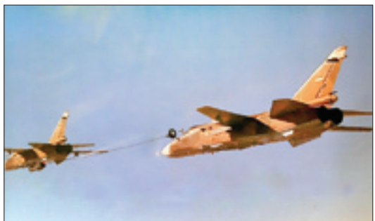
سوختگیری یک سوخو ۲۴ فنسر از فنسر دیگر
