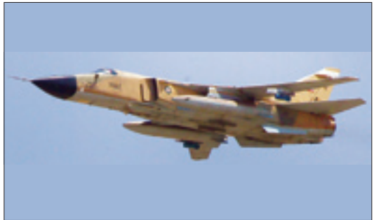
هواپیمای سوخو ۲۴ در حال حمل دو مخزن سوخت زیر بال در همان جایگاه نصب موشک کروز
