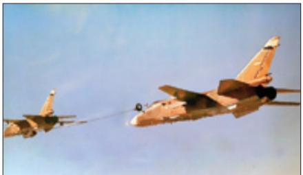
سوختگیری یک سوخو ۲۴ فئسر از فئسر دیگر
