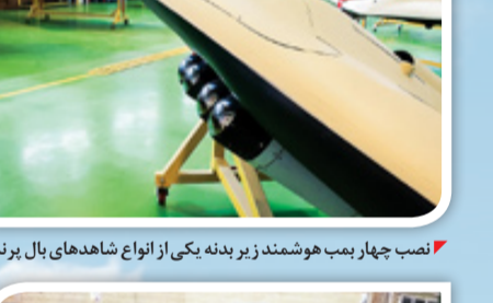
نصب چهار بمب هوشمند زیر بدنه یکی از انواع شاهدهای بال برنده
