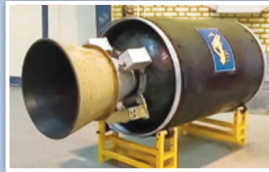
موتور سلمان به عنوان مرحله دوم در قاصد ۱ قائم ۱۰۰ استفاده می‌شود
