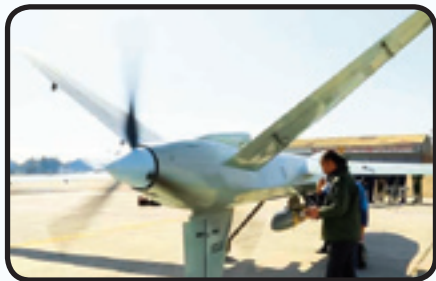
بخش انتهایی بدنه، دم Y شکل و بخش متحرک با عملکرد رادار نصب شده زیر موتور
