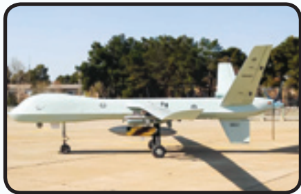
بخش مثلثی ریشه بال در محل اتصال به بدنه و بالچه نوک بال در این تصویر از کمان ۲۲ مشهود است
