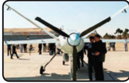
شش جایگاه نصب محموله زیر بال‌های کمان ۲۲ در این تصویر دیده می‌شوند
