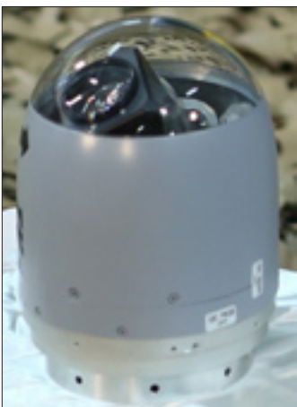
نمونه‌ای از جست‌وجوگرهای اپتیکی که به بمب‌های سری قائم‌قابلیت نقطه‌زنی می‌دهد
